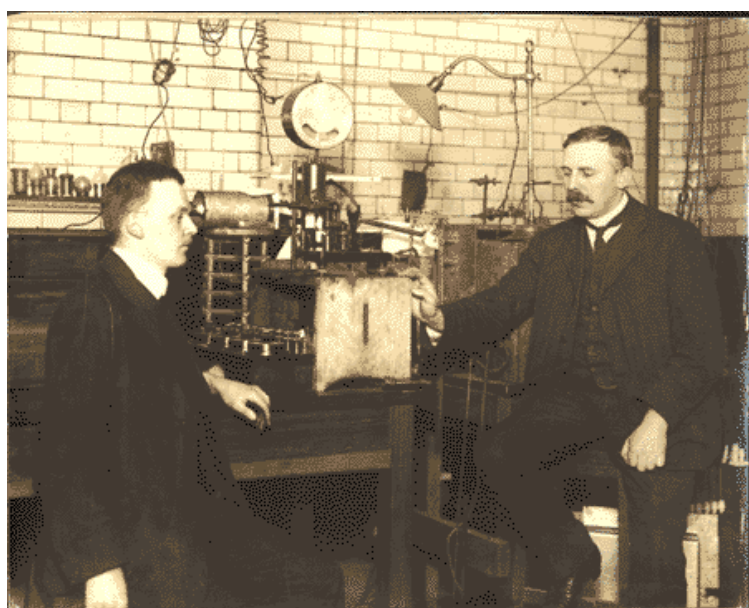
Obr. 3: Vlevo: Rutherford s Marsdenem u svého zařízení, jehož schéma je znázorněno nahoře. Částice alfa vycházející ze zdroje R se rozptýlily na zlaté fólii F a dopadaly na vrstvu ZnS na předním okénku kukátka M které se otáčelo kolem osy kolmé na rovinu obrázku a do něj se dívaly střídavě Geiger s Marsdenem.
