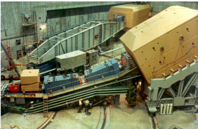
Obr. 14: Schématické uspořádání experimentu v němž byly ve SLAC rozptylovány elektrony na protonech (nahore) a ramena spektrometru, která umožňovala měřit úhly a energie rozptýlených elektronů.
