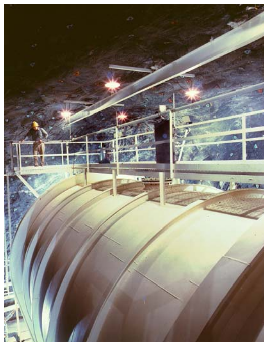
Obr. 4: Vlevo původní Davisova aparatura v podzemí dolu na vápenec, v níž bylo 4000 litrů čistícího prostředku perchloretylenu. Vpravo stokrát větší Davisův detektor v dole na zlato Homestake, v němž zaznamenal asi 2000 případů srážek slunečních neutrin
