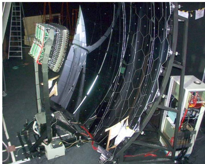
Obr.18 Zrcadla pro Observatoř Pierra Augera vyrobená v SLO.
