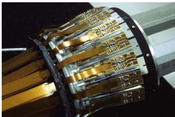
Obr. 7: Pixelový detektor DELPHI vyvinutý ve spolupráci s IHEP ve Vídni
