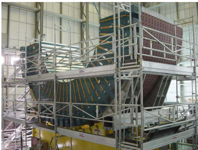
Obr.15: Testovací sestavení hadronového kalorimetru TILECAL v pozemní hale v CERN.
