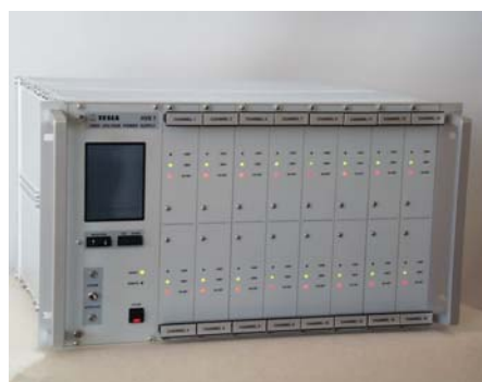
Obr. 13: Vysokonapěťový zdroj se 16 kanály vyvinutý ve FZÚ.
