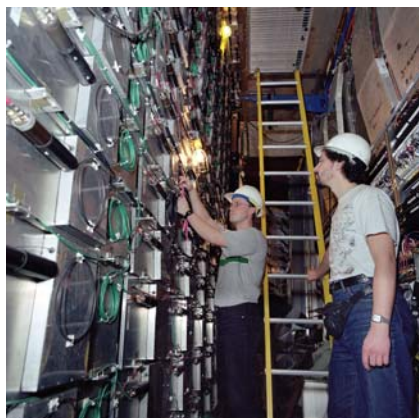
Obr. 8: Vlevo: Zdeněk Kotek při kontrole vysokonapěťových rozvodných skříní pro mionový detektor v laboratoři FZÚ. Vpravo: Alexander Kupčo a Karel Soustružník (MFF UK) při instalaci kalibračního zařízení pro mionové scintilační detektory ve Fermilab.
