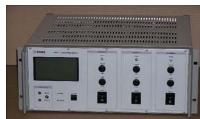
Obr. 14: Jedna z 22 jednotek tří-kanálových zdrojů stejnosměrného napětí 200 V.
