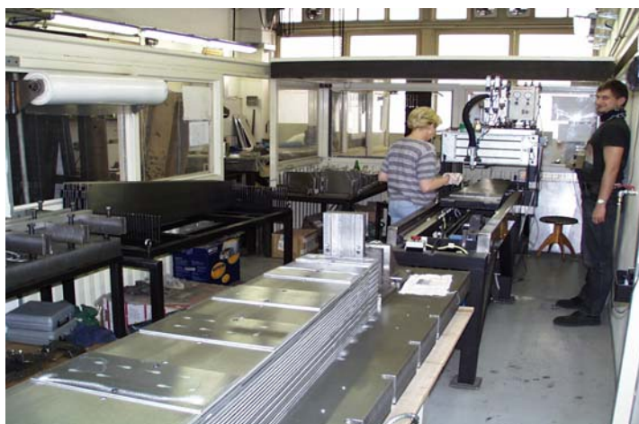
Obr. 12: Výroba 309 částí TILECAL ve FZÚ. Vzadu poloautomatické zařízení na dávkování a nanášení lepidla. V popředí ocelový stůl, na němž je část sestavována.
