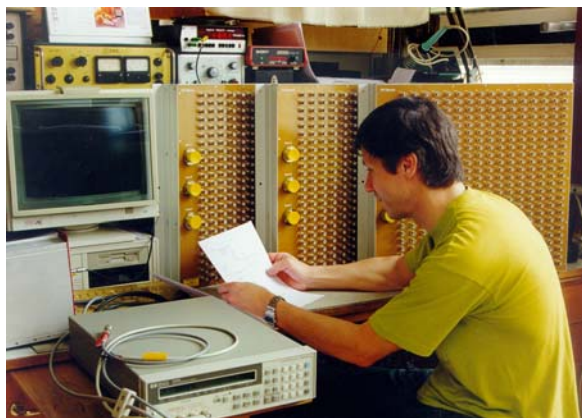
Obr. 8: Vlevo: Zdeněk Kotek při kontrole vysokonapěťových rozvodných skříní pro mionový detektor v laboratoři FZÚ. Vpravo: Alexander Kupčo a Karel Soustružník (MFF UK) při instalaci kalibračního zařízení pro mionové scintilační detektory ve Fermilab.
