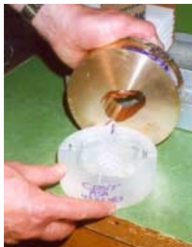
obrázek 8: Kolimátory a kompenzátory, používané pro uzpůsobení oblasti ozařování podle tvaru nádoru (Harvard Cyclotron Laboratory, USA)
