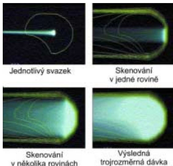
obrázek 9: Princip aktivního skenování nádorového ložiska [2].
