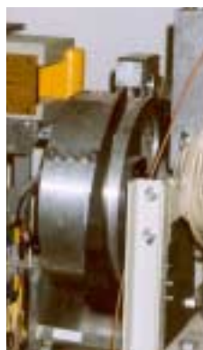
obrázek 19: Grafitový klín pro zbrzdění částic
