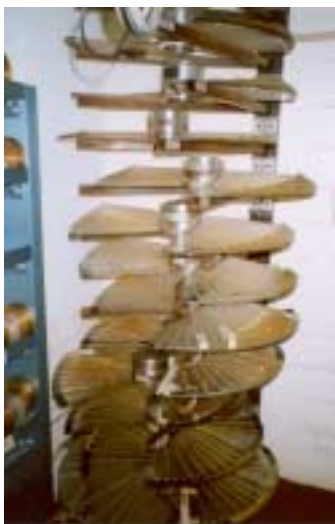
obrázek 6: Stupňovité disky pro hloubkové rozšíření svazku (Harvard Cyclotron Laboratory, USA)
